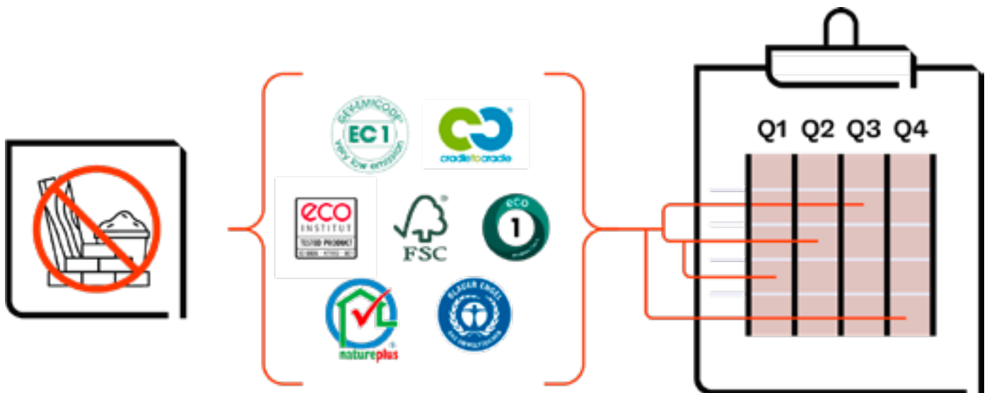
Abbildung 2: Vereinfachte Darstellung der DGNB ENV 1.2 Anforderungen an Schad- und Risikostoffe mit Bezug zu verschiedenen Produktzertifizierungen und Labels, eingeteilt durch Qualitätsstufen QS1-4 [Quelle: eigene Darstellung]
